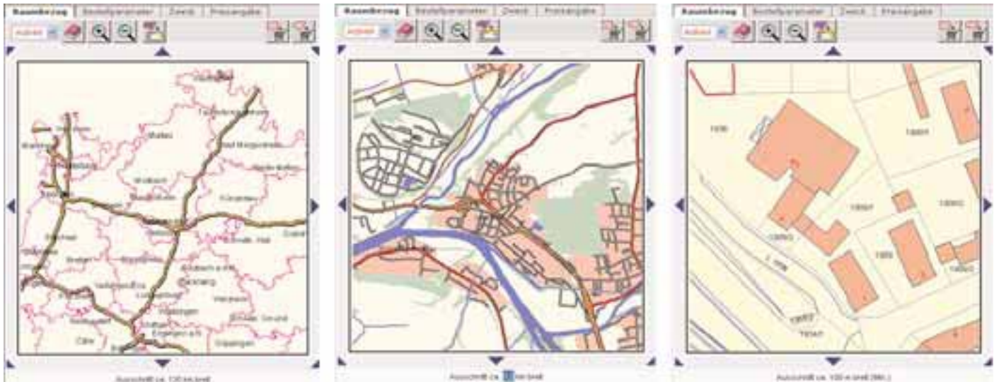
Abbildung 2: Verschiedene Kartenbilder aus GEODIS, abhängig von der Zoomstufe. Für viele Fachanwendungen sind vor allem die Daten des DLM (Mitte) und der ALK (rechts), auf die im Artikel Bezug genommen wird, von Bedeutung.
