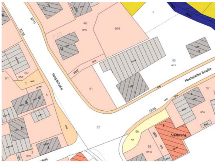
Abbildung 5: Auszug aus der ALK erzeugt aus Linien und Flächenobjekten. Die Texte sind Beschriftungen von unsichtbaren Linien.
